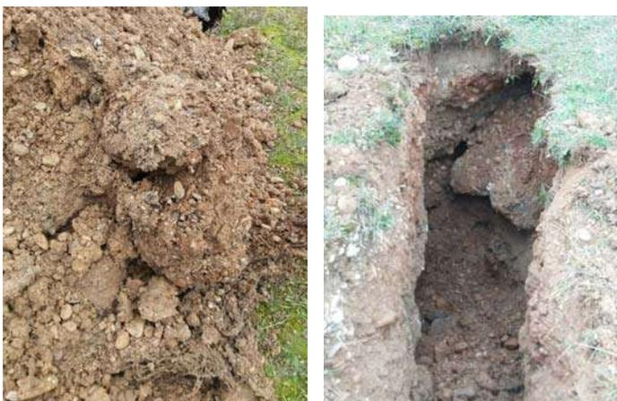
En profondeur ils sont bouillants au creusement. Nous avons probablement eu le refus de certains de nos essais au pénétromètre dynamique en raison de leur compacité ponctuelle en tête. Nos sondages P1, P2, P5, P6 et P9 ont été arrêtés dans les remblais entre 3,2 m et 3,8 m de profondeur.
